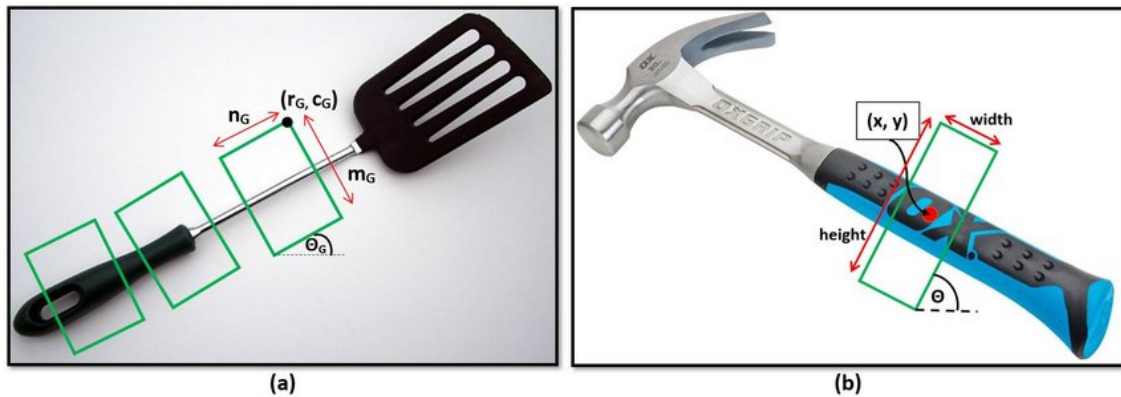
FIGURE 2.6 – (a) La représentation par JIANG et al. [75] : Sommet supérieur (r_G, c_G) , longueur m_G , largeur n_G et son angle par rapport à l'axe des x , \theta_G pour un ustensile de cuisine. Il peut y avoir plusieurs prises définies comme indiqué. (b) La représentation simplifiée par REDMON et al. [147] pour un marteau, montrant son centre de préhension à (x, y) orienté selon un angle de \theta à partir de son axe horizontal. Le rectangle a une largeur et une hauteur de w et h respectivement. Image provenant de [24].
