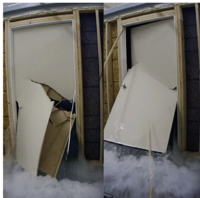
FIGURE 1.24 : Expériences de rupture de porte sous l'effet de la pression de l'eau sur une porte creuse en bois (à gauche) et pleine en acier (à droite), d'après [148]
