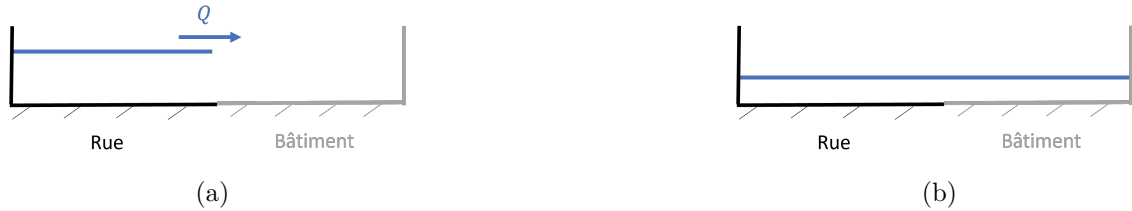
FIGURE 2.24 : Schéma du remplissage d'un bâtiment jusqu'à équilibre des niveaux d'eau avec la rue ( cas A ). (a) État initial. (b) État final.
