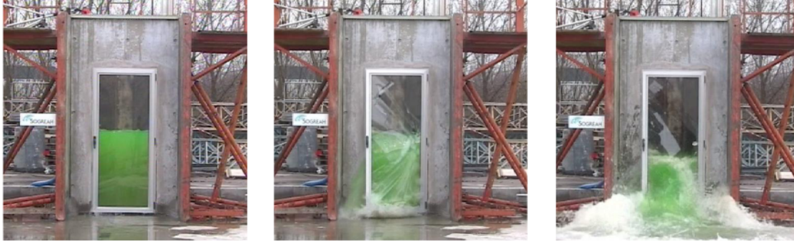
FIGURE 1.23 : Expérience de rupture d'une porte-fenêtre sous la pression de l'eau, d'après [25, 26]
