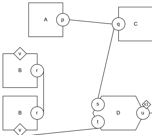
FIGURE 10 – Graphe de site. Un graphe de sites est constitué de nœuds qui indiquent les occurrences de certains composants, ici  $A$ ,  $B$ ,  $C$  et  $D$ . Ces composants sont associés à une liste de sites d'interaction, ici  $p$ ,  $q$ ,  $r$ ,  $s$ ,  $t$ ,  $u$  et  $v$ . Les sites peuvent être libres ou liés par paire. Ces sites peuvent posséder des propriétés, plus communément appelé *état*, comme ici le site  $u$  de  $C$  qui possède un état  $x1$ .
