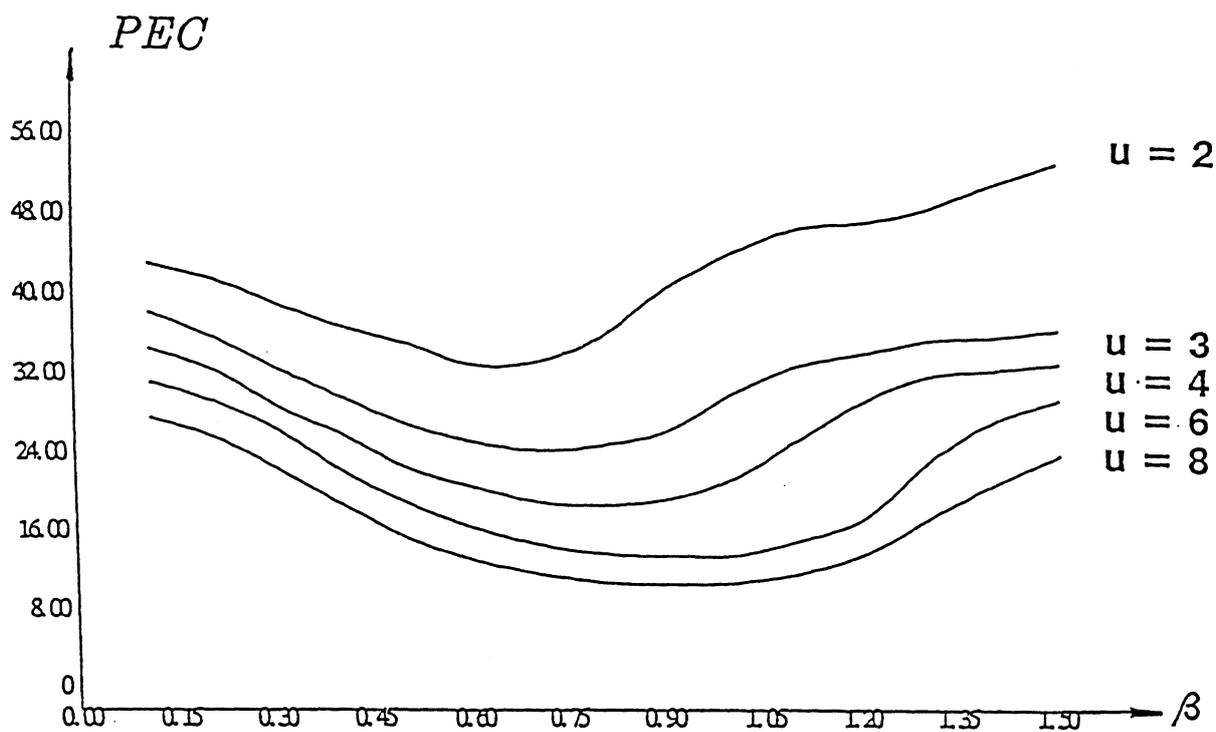
Figure 3.4: MPM: variation du  $PEC$  suivant le paramètre  $\beta$ .
