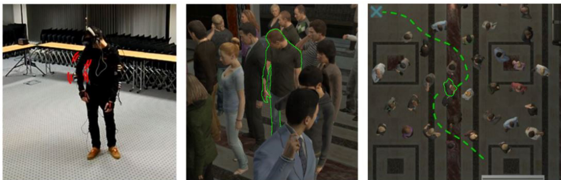
FIGURE 2.36 – Illustration de l'expérience sur l'effet du retour haptique des collisions lors de la navigation dans une foule : équipés de bracelets à retour haptique sur chaque bras et avant bras, les participants, dont le point de départ est illustré par la croix bleue, devaient traverser une foule d'humains virtuels statiques afin de rejoindre le tableau d'affichage du hall de gare. Lorsqu'ils étaient activés, les bracelets vibraient si les participants entraient en collision avec un humain virtuel.
