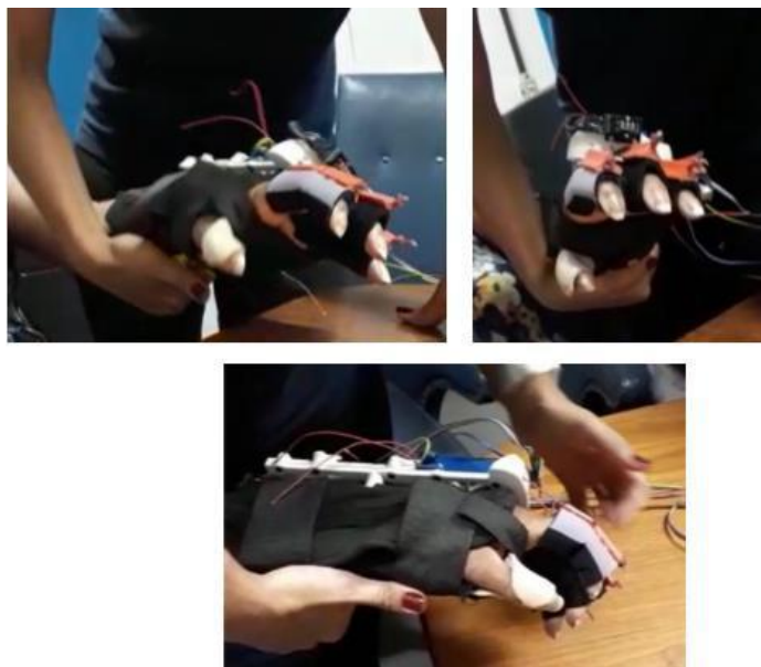
Figura 66 – Flexão da falange distal ao realizar movimento de extensão dos dedos
