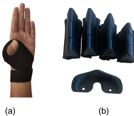
Figura 104 – Módulos mão órtese híbrida (a) suporte para polegar (b) dedeiras com falanges artificiais e metacarpo artificial
