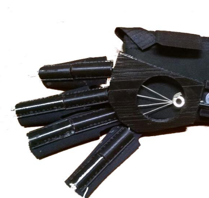
Figura 54 – Metacarpo artificial fixado no componente dorsal do antebraço
