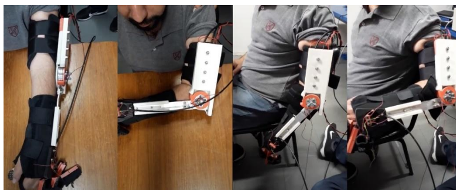
Figura 65 – Módulo do cotovelo com reforço estrutural paciente utilizando
