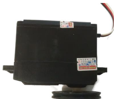
Figura 58 – Servomotor responsável pela movimentação dos dedos
