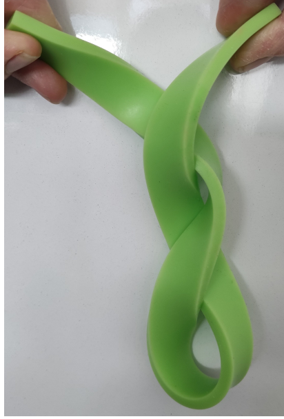
FIGURE 6.7 – Un plectonème de ruban (photographie). Le ruban emmagasine de la torsion qui donne cette forme caractéristique.
