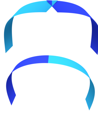
FIGURE 3.2 – Prendre le vecteur courbure constant par élément conduit à des règles discontinues, et donc à des éléments disjoints (en haut); en revanche, une courbure normale linéaire et une continuité des règles, mène à une surface de ruban lisse (en bas).
