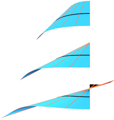
FIGURE 2.6 – Trois configurations d'un ruban. En haut les règles ne se croisent pas. Au milieu, elles se touchent au bord du ruban formant ainsi un cône dont le sommet est le point d'intersection, appelé aussi point singulier, on nomme cette configuration événement de Wunderlich. En bas les règles se croisent au milieu du ruban, on voit clairement un point singulier apparaître, pour former une telle configuration on devrait déchirer la surface.
