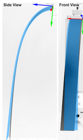
FIGURE 4.8 – Expérience de la poutre console : le ruban expérimental (en gris foncé) est fixé horizontalement d'un côté et tombe sous son propre poids. La prédiction de notre modèle (en bleu) est projetée sur l'image réelle pour comparaison. Le ruban réel est découpé dans une feuille de PET (Polyethylene terephthalate), avec comme dimensions 29\text{cm} \times 3\text{cm} \times 0.143\text{mm} . Expérience réalisée par Victor Romero.
