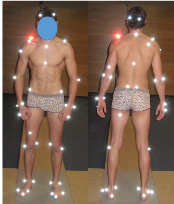
FIGURE 2.3 – Placement des marqueurs sur les repères anatomiques selon les recommandations de l'ISB (International Society of Biomechanics) [Wu et al. 2005]
