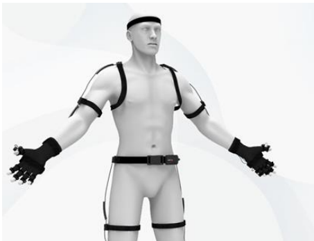
FIGURE 2.4 – Système ambulant permettant de mesurer la cinématique du corps humain à partir des centrales inertielle. Source (irsst.com)
