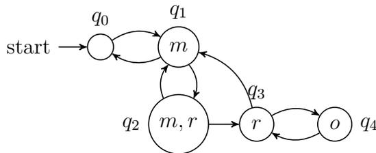
FIGURE 5.2 – Modélisation d'un système représentant une navette
