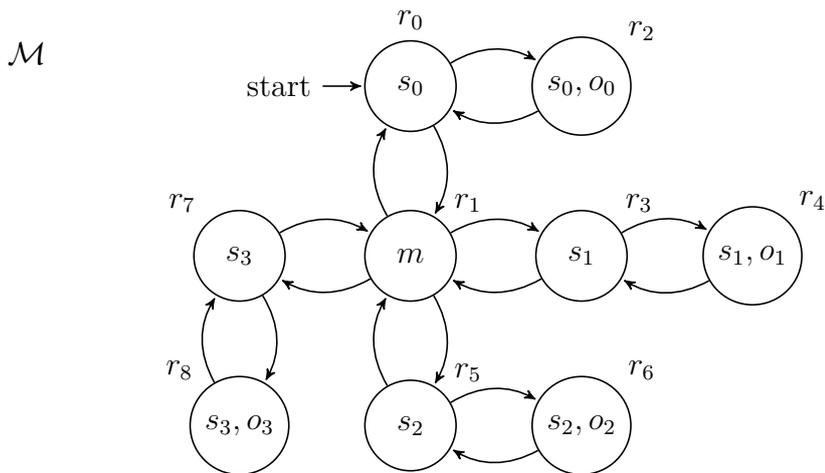
FIGURE 5.1 – Modèle pour un ascenseur à trois étages
