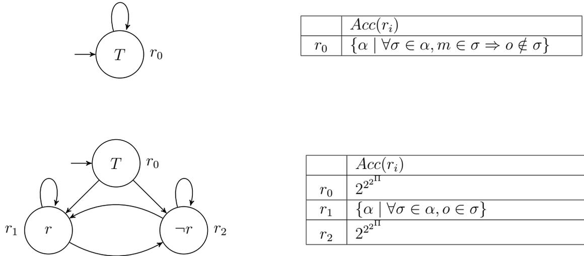
FIGURE 8.3 –  $\mathcal{A}_1$  traduit l'interdiction d'ouverture de la porte si la navette est en mouvement, tandis que  $\mathcal{A}_2$  représente l'obligation d'ouverture de la porte à la demande du passager.
