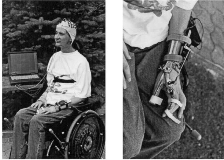
Figure 2: La première orthèse introduit dans le domain des interfaces cerveau-machine (ICM), de Pfurtscheller et al. [20]. Le sujet devait imaginer un mouvement de sa main pour faire fonctionner l'appareil, qui se base directement sur les signaux bioélectriques de son cerveau.
