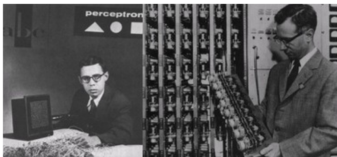
Figura 1.1: La figura de la izquierda muestra a Rosenblatt con el sensor del Mark I, el hardware diseñado a principios de la década de 1960 para implementar el perceptrón. En la figura de la derecha se ve a Charles Wightman sosteniendo un conjunto de 8 potenciómetros que representaban los aportes sinápticos del perceptrón.
