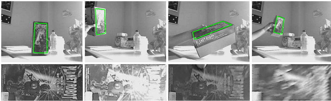
FIGURE 4.3 – Suivi par recalage d'image en utilisant l'information mutuelle comme mesure de similarité entre images [DM10]. L'homographie entre la référence (en bas) et l'image courante (en haut) est calculée à chaque pas de temps.
