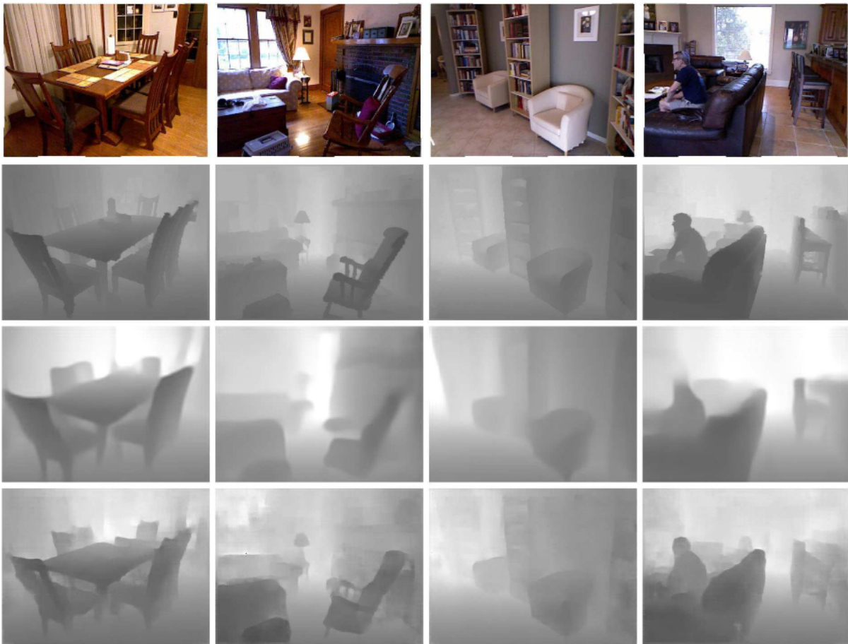
FIGURE 6.4 – Exemples de cartes de profondeur obtenues par des CNN à partir de l'image uniquement. Images RGB en entrée du CNN (première ligne). Vérité terrain (seconde ligne). Résultats obtenus par la méthode [LRB + 16] (troisième ligne). Résultats obtenus par la méthode [HWH18] (dernière ligne).
