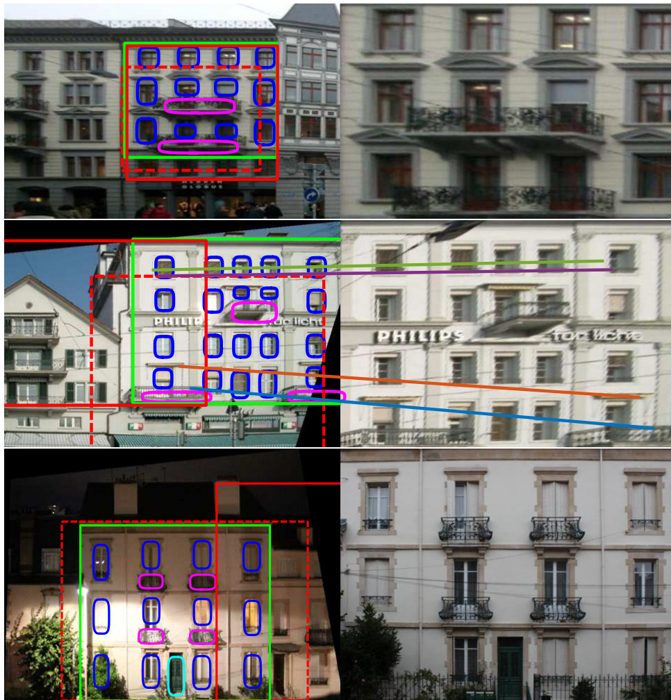
FIGURE 4.9 – Exemples de résultats où d'autres méthodes échouent (rectangles rouges) quand la notre réussit (rectangles verts). Le recalage initial est représenté en trait hachuré, les recalages finaux en trait plein. En-haut : le recalage basé sur l'intensité tombe dans un minimum local. Au milieu : le recalage par SIFT/RANSAC échoue en raison du caractère symétrique de la façade. En-bas : le grand changement d'illumination fait échouer la méthode par corrélation de phase.
