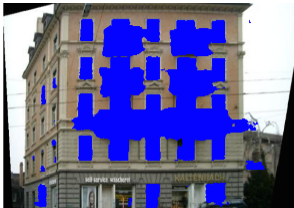
FIGURE 4.6 – Points X pour l’image cible I . Seuls les points susceptibles d’être caractéristiques d’un élément de façade ( P(l_j|i, I) \geq 0.01 ) sont considérés.
