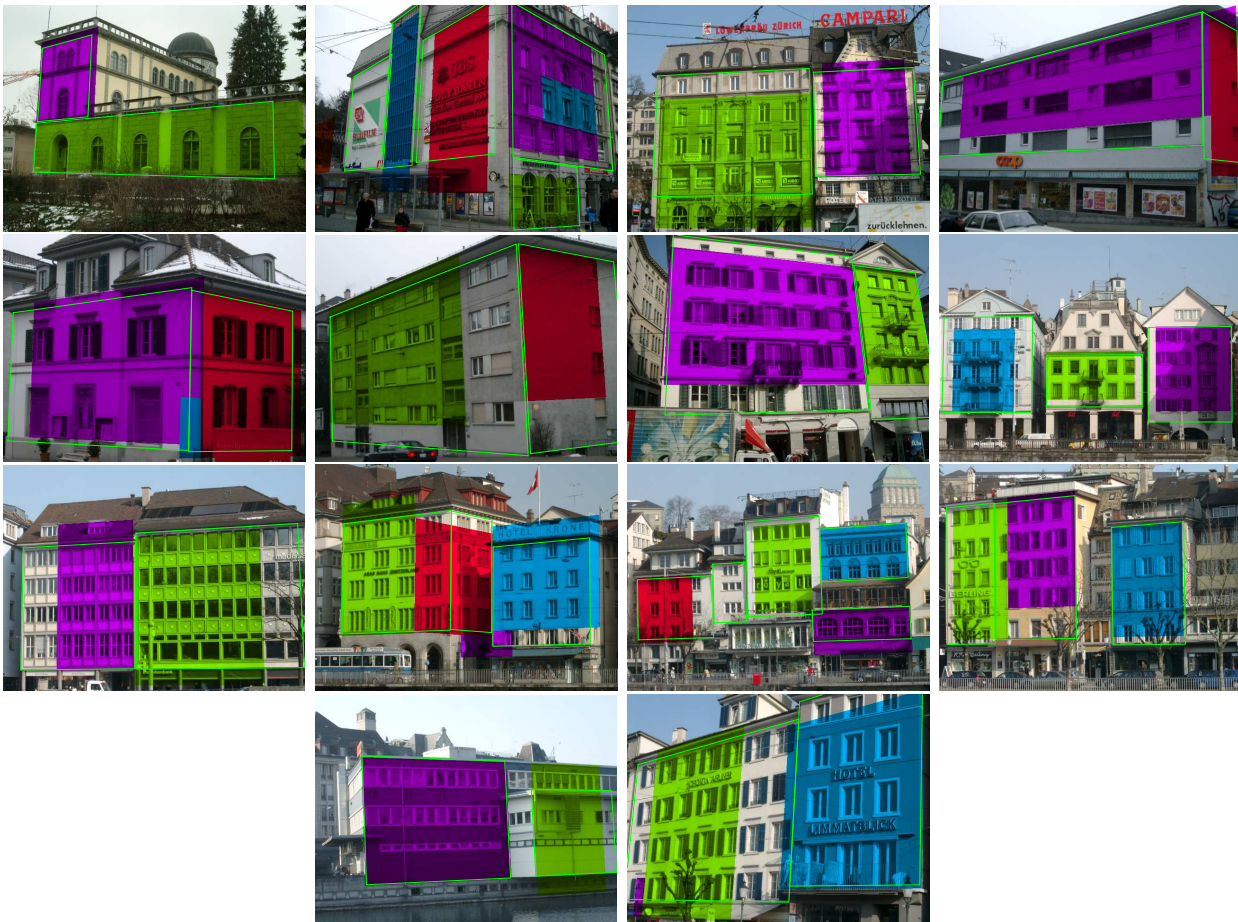
FIGURE 3.10 – Exemples de résultats de la méthode complète sur la base ZuBuD. Les polygones verts représentent les façades de la vérité terrain. Toutes les façades montrées dans cette figure ont été correctement reconnues.
