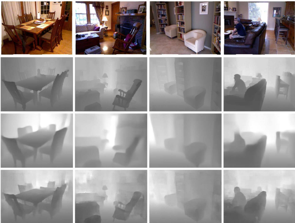
FIGURE 6.4 – Exemples de cartes de profondeur obtenues par des CNN à partir de l'image uniquement. Images RGB en entrée du CNN (première ligne). Vérité terrain (seconde ligne). Résultats obtenus par la méthode [LRB + 16] (troisième ligne). Résultats obtenus par la méthode [HWH18] (dernière ligne).
