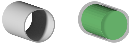
(b) Modèle spécifique (en vert) dans le cas d'un objet présentant des zones de faible épaisseurs (à gauche).
