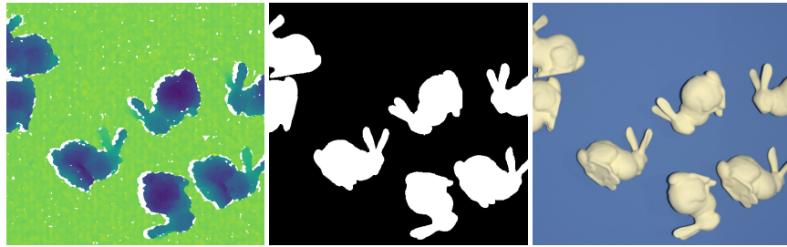
(a) Données d'entrée : image de profondeur, masque de segmentation de l'objet (optionnel), et image RGB pour visualisation.
