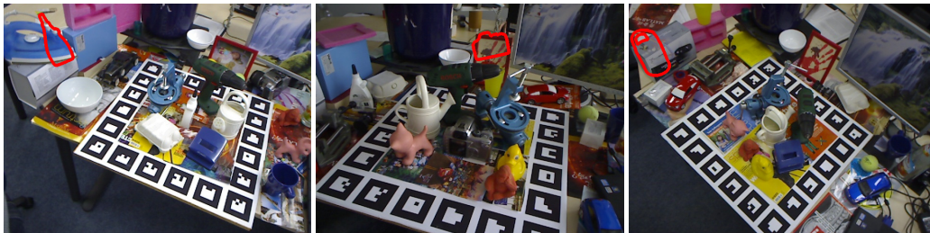
FIGURE 5.26 – Échecs de localisation typiques observés sur le jeu de données LINEMOD (l’objet à localiser est au centre de la planche de marqueurs).
