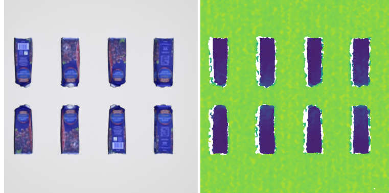
(b) Rendu synthétique RGBD de caractéristiques proche de celles des images réelles. La résolution limitée des images de profondeur rend difficile de discerner l'orientation de l'objet sans considération de sa texture.
