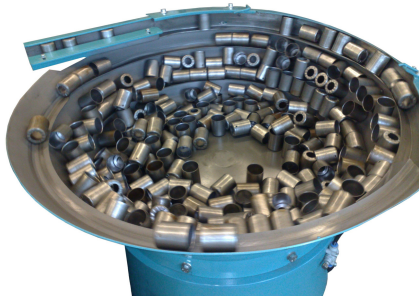
(a) Solution mécanique de dévracage : le bol vibrant (AVITEQ).
