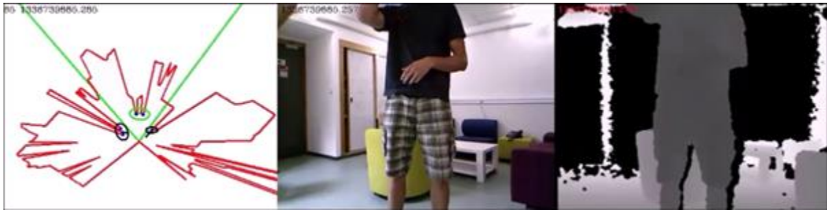
Figure 12 : Exemple de perception embarquée sur notre robot. À gauche, la vue du télémètre laser avec la détection des 3 piétons entourant le robot (ellipses). Au centre la vue RGB, à droite la caméra de profondeur.
