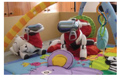
Figure 3: L'expérience du terrain de jeux ou Playground (Oudeyer and Kaplan, 2006) : un robot choisit ses activités au cours du temps, en fonction de ses progrès d'apprentissage. L'activité comprend la saisie et le toucher d'objets, ainsi que la communication avec un pair.
