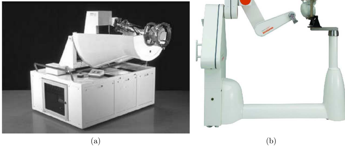
FIGURE 1.6 – (a) Le robot de neurochirurgie Minerva. ;(b) Le robot de neurochirurgie Neuromate.
