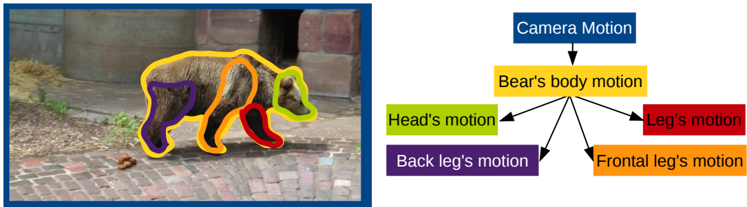
Figure 0.1: Hiérarchie de mouvement. Illustration d'une entité mobile avec ses parties mobiles, et de la structure hiérarchique de la composition du mouvement.
