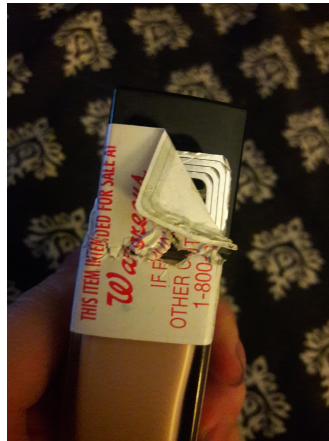
FIGURE 5.2 – Exemple d'un produit du commerce avec tag RFID
