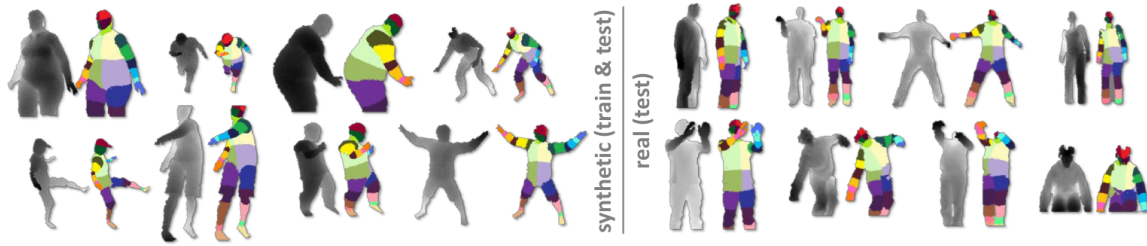
FIGURE 1.2 – Un extrait de la base d’apprentissage utilisée par Microsoft pour apprendre leur classificateur. A gauche les images synthétiques et à droite les images réelles. Pour chaque image de profondeur (en niveau de gris), un étiquetage est fait pour chaque pixel pour identifier la partie du corps à laquelle ce pixel appartient.
