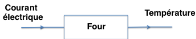
FIGURE 5.1 – Représentation d'un contrôle à boucle ouverte
