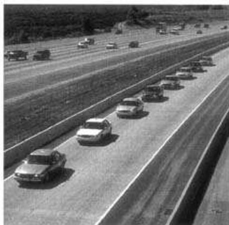
FIGURE 2.1 – Projet PATH : platooning de huit véhicules sur une autoroute.
