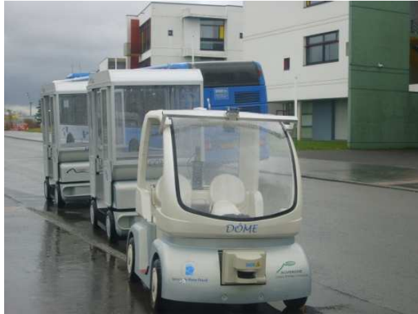
FIGURE 2.2 – Projet Cristal : platooning de trois véhicules.
