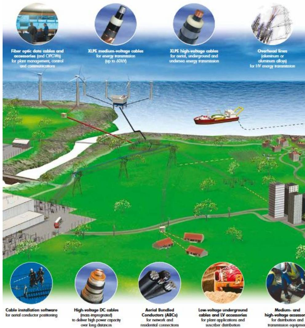
FIGURE 1: Différents types de câbles et leurs domaine d'application (Source : nexans.fr)
