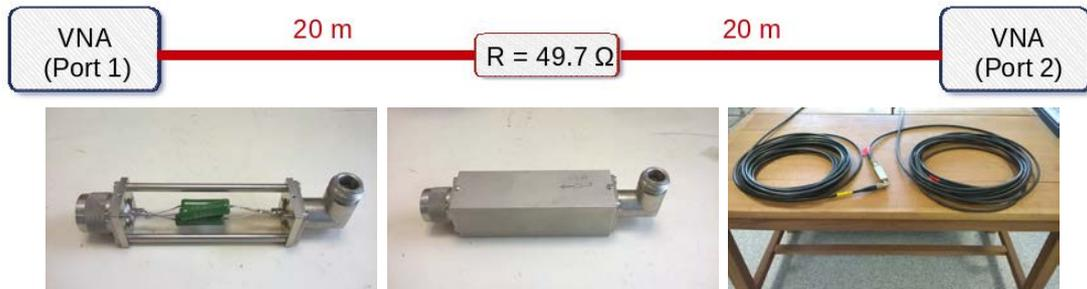
FIGURE 4.3: Expérience 1 : câble RG214 de 40 m affecté d'un défaut résistif localisé de  $49.7\Omega$
