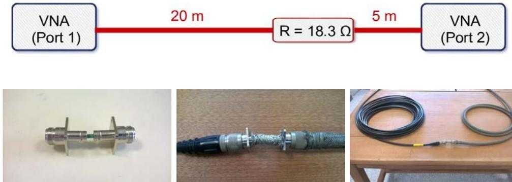
FIGURE 4.5: Expérience 2 : câble RG214 de 25 m affecté d'un défaut résistif localisé de  $18.3\Omega$
