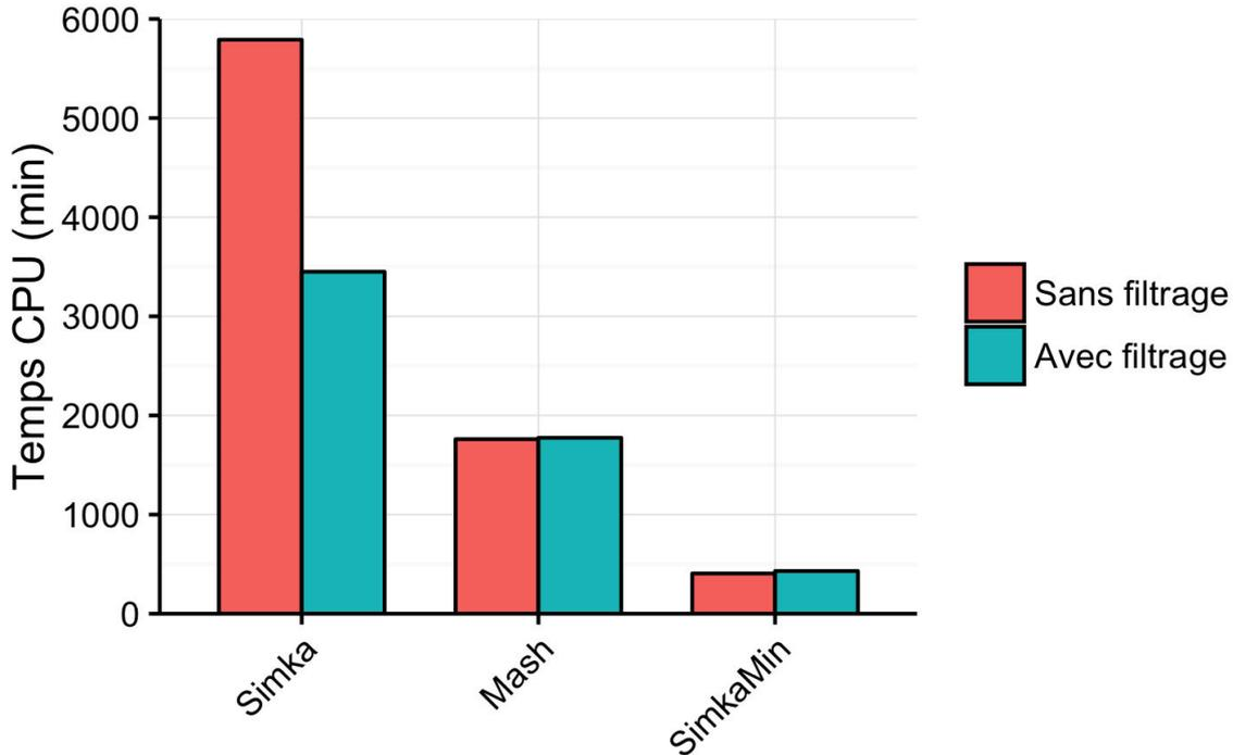
**FIGURE 5.11. Temps CPU de Simka, Mash et SimkaMin.** Les tests ont été effectués sur 138 jeux de données intestinaux du projet HMP. Les outils ont été lancés avec  $k = 31$ , avec et sans filtrage des  $k$ -mers vus une seule fois. SIMKAMIN et MASH ont utilisé 100k  $k$ -mers distincts par jeu. La machine de test est équipée d'un processeur Intel E5-2640 de 20 cœurs (2.50 GHz) et 264 Go de mémoire.
