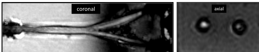
Figure 12. Acquisition sur fantôme de bifurcation carotidienne. On observe une inhomogénéité du flux en rapport avec un défaut d'étanchéité du système d'écoulement du fluide. Par ailleurs, le contraste avec l'environnement périvasculaire est mauvais en raison de l'absence de milieu agar-agar lors de cet essai.
