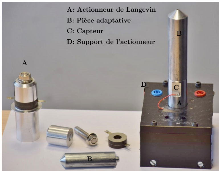
FIGURE 3.10: Association de la pièce adaptative avec le transducteur de Langevin
