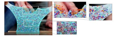
**Figure A.30:** Effets des changements topologiques dans l'image sur l'objet virtuel (turquoise) avec les characteristics dans l'image (points bleus) et sur l'objet virtuelle (points rouges) qui sont connectés par des ressorts (lignes orange): À gauche: objet complet avec objet virtuel superposé; À droite: région de la coupure, région sans forte déformation et une région à forte déformation
