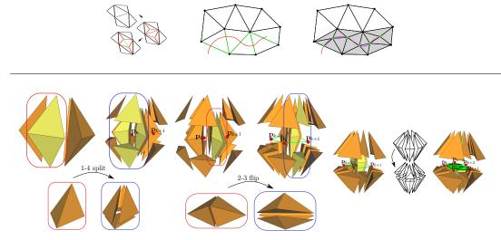
Figure A.25: Partie supérieur: algorithme de remaillage en deux dimensions; Partie inférieur: Algorithme de remaillage en trois dimensions autour d'un arêt
