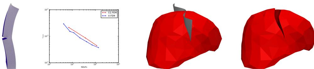
**Figure A.24:** Analyse de convergence montrant l'erreur quadratique moyenne du X-FEM par rapport à la solution FEM conventionnelle sur un exemple de coupe d'un faisceau (*left*); Un foie avec 888 éléments tétraédriques linéaires est coupé par une lame sinusoïdale: non déformé avec la surface de coupe (*middle right*), et la déformation après la coupe (*right*)
