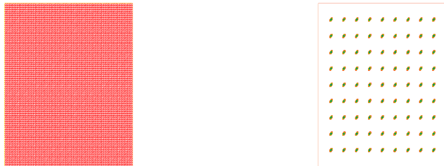
Figure 5.5.3: Maillage pour calculer les observations (à gauche) et positions des points d'observation (à droite).
