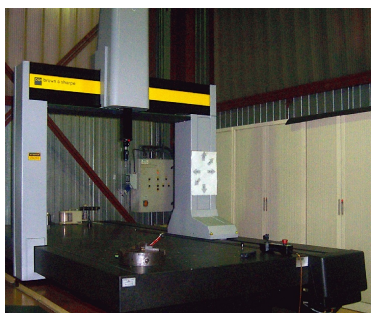
FIGURE 5.1 – Machine à mesurer tridimensionnelle, Brown & Sharpe, CMW
