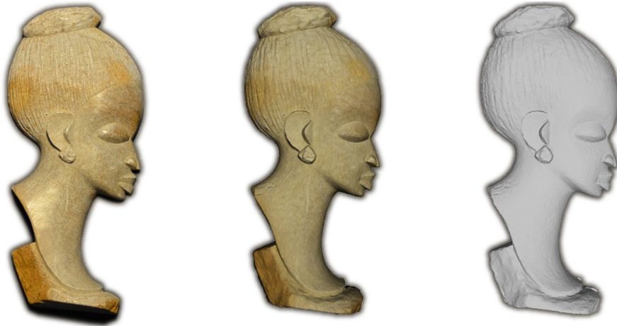
FIGURE 14– Exemple de reconstruction par photogrammétrie [155] sur un objet utilisé dans le chapitre 4. Photographie de l'objet réel (gauche), rendu de l'objet 3D reconstruit avec (milieu) et sans couleurs (droite). La reconstruction s'est faite à partir d'une vingtaine de photos. L'objet provient d'une collection privée.
