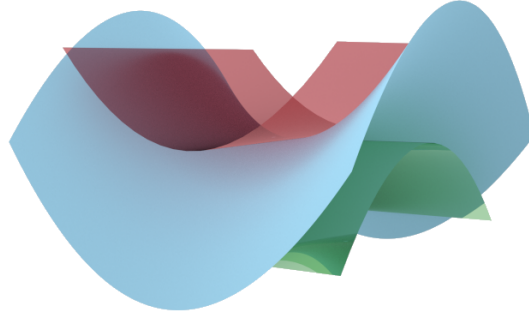
FIGURE 45– Illustration de l’ambiguïté lors de l’approximation d’une selle de cheval en utilisant un cylindre parabolique. La selle de cheval (bleu) peut être approximée par deux cylindres paraboliques différents (rouge et vert).
