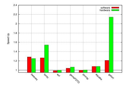
Figure 3: Speed-Up de la Memoization matérielle pour les Benchmarks SPEC 64k table d'entrée, Intel Ivy bridge 2.3 GHz.
