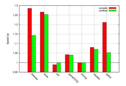
Figure 1: Speed-Up par Memoization pour les benchmarks SPEC 64k table d'entrée, Intel Ivy bridge 2.3 GHz.
