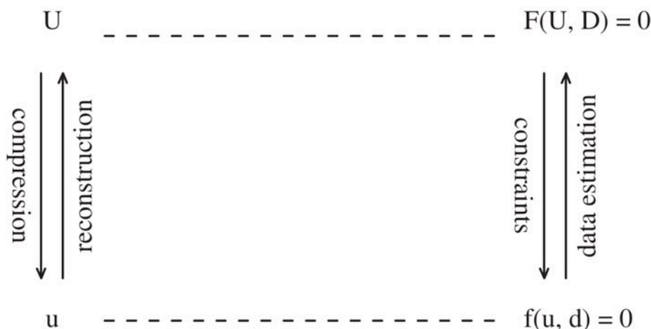
FIGURE 3.7 – Représentation schématique de l’Heterogeneous Multiscale Method – Deux niveaux de description d’un système sont associés. Des opérateurs de reconstruction et de compression permettent de faire la traduction de l’un à l’autre, l’un définissant des contraintes pour raffiner la description tandis que l’autre résume un ensemble de données en des variables macroscopiques, d’après [Weinan et al., 2003]
