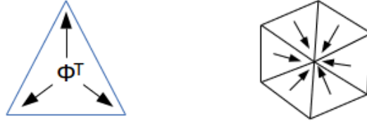
FIGURE 6.16 – Principe des schémas RDS. À gauche : Distribution du résidu total aux sommets du triangle; à droite : somme de la contribution de tous les triangles contenant le sommet i .
