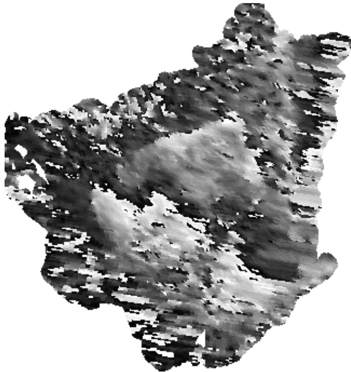
FIG. 4.12 – Interférogramme différentiel du glissement de terrain géoréférencé.
