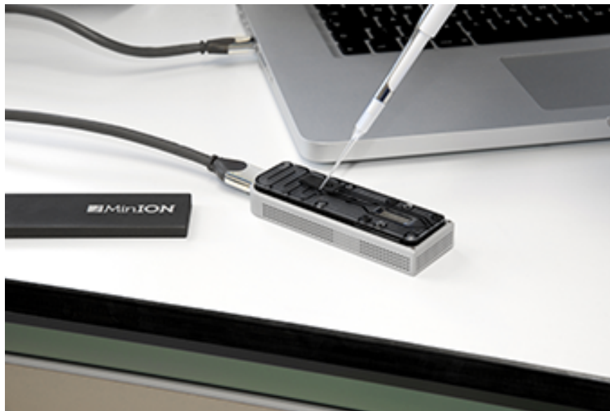
FIGURE 5.1 – Le séquenceur de poche MinION
