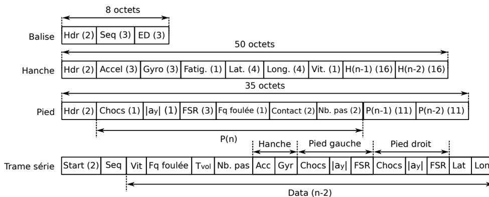
Figure 3.5 – Constitution des paquets radio et de la trame série à la séquence  $n$ , illustrant également la méthode de codage répétitif. La taille des données est en octets. Les données d'accéléromètre et de gyroscope de la hanche n'ont pas été utilisées.
