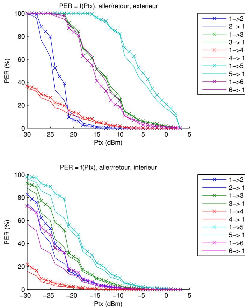
Figure 4.9 – Estimation du PER entre les différents nœuds et le coordinateur (nœud 1), en fonction de la puissance d'émission  $P_{tx}$ , en extérieur, puis en intérieur.
