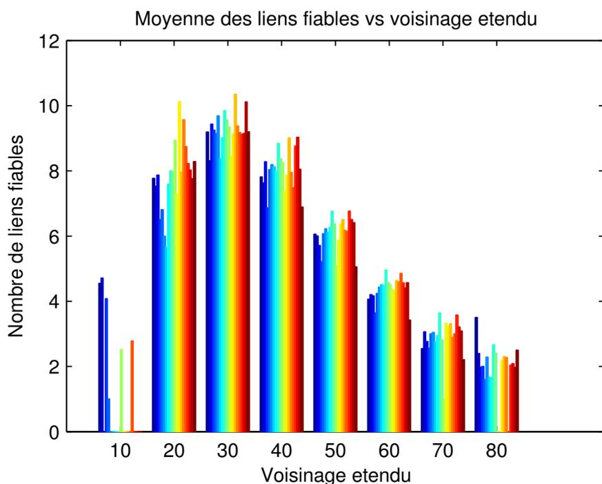
Figure 7.7 – Nombre moyen de liens fiables (réception  $\geq 6p/s$ ) en rapport avec le voisinage étendu. Chaque barre de couleur de l’histogramme représente le paramètre mesuré pour chaque nœud logger.
