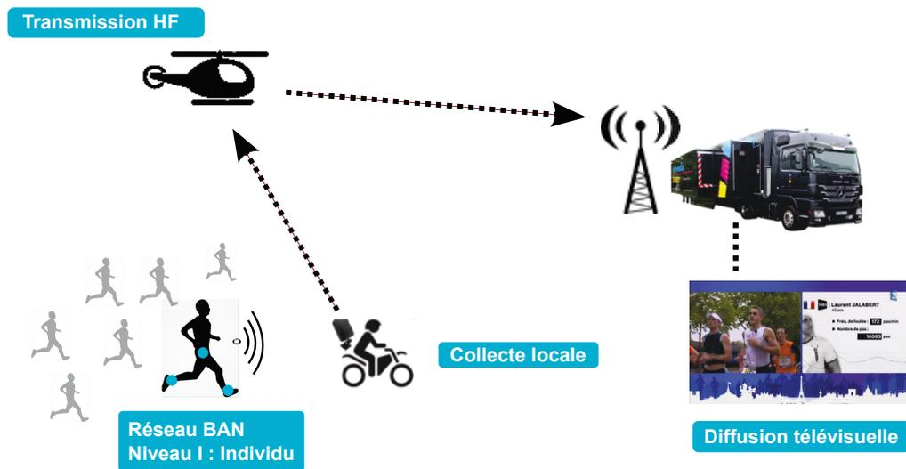
Figure 3.1 – Infrastructure destinée à la collecte de données sur un coureur lors du Marathon de Paris 2012. Un seul individu est équipé de trois capteurs, une moto le devance et assure la collecte locale des données, qui sont ensuite acheminées jusqu'à l'incrustation TV.
