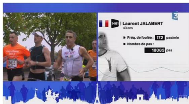
Figure 3.6 – Capture d'écran de l'intégration en direct des données issues du BAN (fréquence de foulée, nombre de pas) au flux vidéo lors de la retransmission du Marathon de Paris, le 15 avril 2012. L'incrustation est réalisée pas la société Symah Vision.
