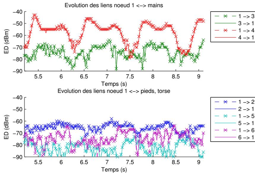
(a) *Haut*: Valeur de la métrique ED mesurée pour les liens du nœud 1 (hanche) vers les nœuds des mains (3 et 4). *Bas*: ED mesurée entre le nœud 1 et les trois autres nœuds (pieds, torse). Ces mesures ont été acquises en extérieur, et présentent les deux sens de propagation.
