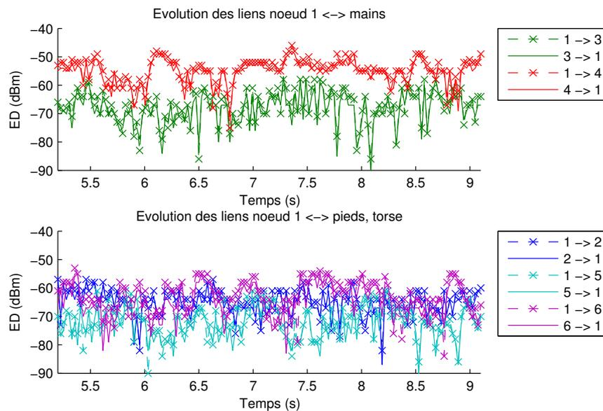
(b) *Haut*: Valeur de la métrique ED mesurée pour les liens du nœud 1 (hanche) vers les nœuds des mains (3 et 4). *Bas*: ED mesurée entre le nœud 1 et les trois autres nœuds (pieds, torse). Ces mesures ont été acquises en intérieur, et présentent les deux sens de propagation.
