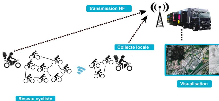
Figure 6.2 – Architecture de l'expérimentation cycliste à petite échelle.
