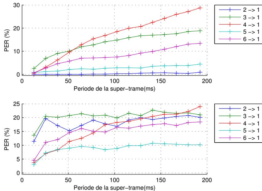
Figure 4.11 – Effet de la période de la super-trame sur les performances de l’algorithme centralisé de prédiction de puissance à partir de la réception à l’instant  $k - n$ ,  $n \in [1; 15]$ , soit une période comprise entre 13 et 195 ms.
