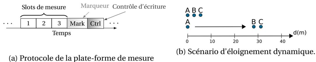
Figure 6.3 – Protocole mis en œuvre sur la plate-forme de mesure, et scénario d'éloignement dynamique. Les nœuds *B* et *C* s'éloignent progressivement de *A*, un marqueur est déclenché chaque fois que le nœud *B* franchit 10 mètres.
