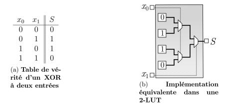
FIGURE 0-1 – Implémentation d'une fonction logique à deux entrées dans la table de vérité d'un FPGA.  $S = x_0 \oplus x_1$ .
