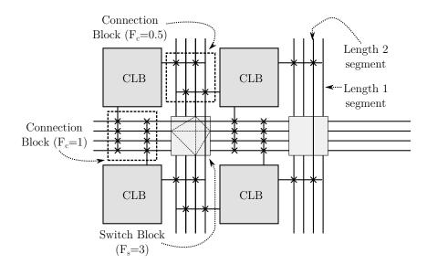
FIGURE 0-2 – Représentation schématique du réseau de routage d'un FPGA.
