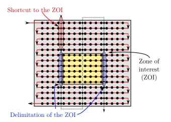
FIGURE 0-9 – Utilisation du registre à décalage amélioré lors de l'insertion d'un tâche de taille  $8 \times 4$  frames.
