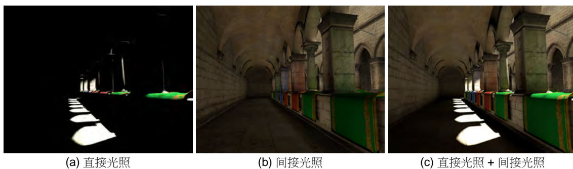
图 1.3 Sponza 场景，在 (a) 中只计算直接光照，(b) 中只计算间接光照，(c) 中计算直接光照和间接光照。
