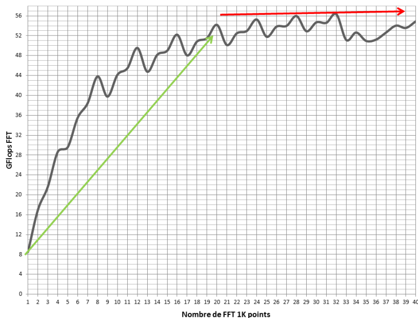
FIGURE 5.6 – Courbe des performances FFT 1024 points sur le GPU Intel Haswell à 40 EU
