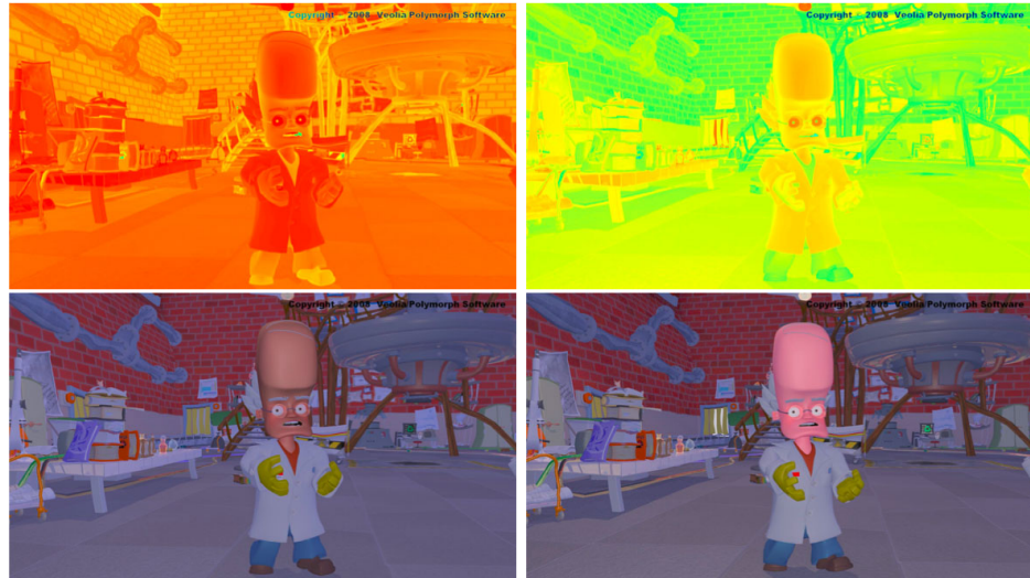
FIGURE 6.6 – Altération de la cohérence du contraste : (en haut) Les images HDR en fausse couleur (bleu : faible valeur de luminance, rouge : grande valeur de luminance), (en bas) Les images LDR correspondantes - Le changement de condition d'illumination entraîne des images HDR plus sombres, ce changement n'est pas respecté dans les images LDR produites.
