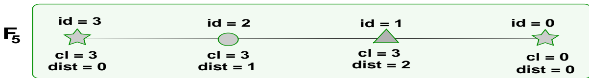
(f) Configuration \gamma_5 : le nœud 1, bien que déjà fixé au nœud 3, devient passerelle.
