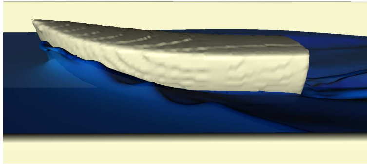
FIGURE 4.25 – Exemple de simulation d'un bateau. La longueur du bateau est 2m et sa vitesse est 2m/s . La ligne triple se déplace sur la coque.
