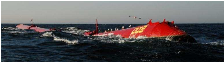
FIGURE 4.15 – Serpent de mer Pelamis. Crédit : Pelamis Wave Power.
