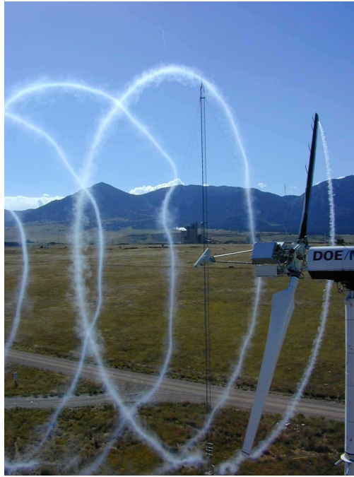
FIGURE 4.12 – Mise en évidence du tourbillon de bout de pale par un lâché de fumée.
