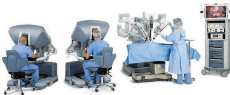
Fig. 1.10 – Robot DaVinci développé par Intuitive Surgical Inc. (Sunnyvale, USA).
